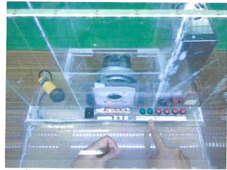
รูปที่ 6 การทำงานของเครื่องดูดฝุ่นในโหมดอัตโนมัติ ไฟส่องสว่างและมอเตอร์ทำงาน เนื่องจากเซนเซอร์ตรวจจับฝุ่นที่เคลื่อนผ่านได้
