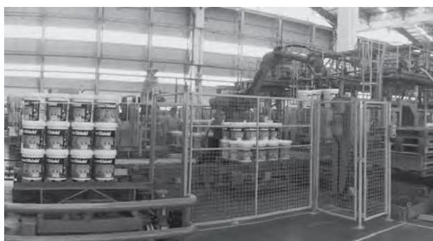
ภาพที่ 2.2 Robot สำหรับเคลื่อนย้ายสินค้า
