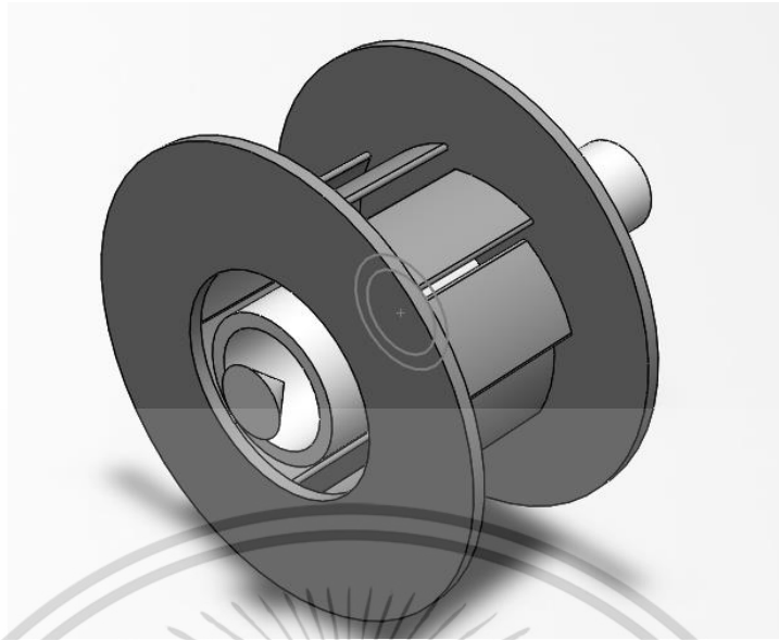
รูปที่ 5.12 หัวพ่นเชื้อเพลิงแข็งชนิดผง (Pulverized burner) และชุดใบบิดโค้ง (Swirl)
