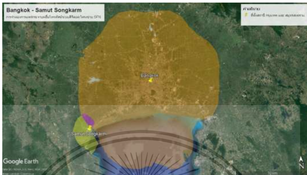
รูป 4.12 แบบรูปการแพร่กระจายสัญญาณด้วยโปรแกรม ATDI ICS Telecom โดยสีม่วงเป็นพื้นที่ทับซ้อนของโครงข่ายความถี่เดียว [62]
