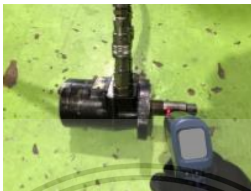
รูปที่ 4.6 วัดความเร็วที่แกนมอเตอร์ไฮดรอลิกส์
