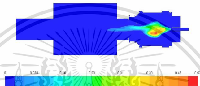
รูปที่ 7. 33 สัดส่วนเชิงมวลของสารระเหยในห้องเผาไหม้จากการติดตั้งวัตถุขวางการไหล ที่ระยะ 20 มิลลิเมตร
