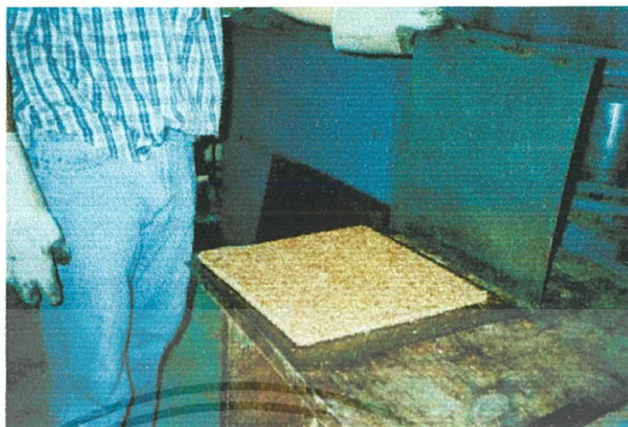
ภาพที่ 3.12 แผ่นประกอบที่ได้จากการอัดขนาดเท่ากับ 350 x 350 x 10 มิลลิเมตร
