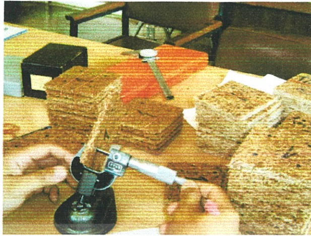
ภาพที่ 3.17 การวัดขนาดความหนาของชั้นทดสอบ
