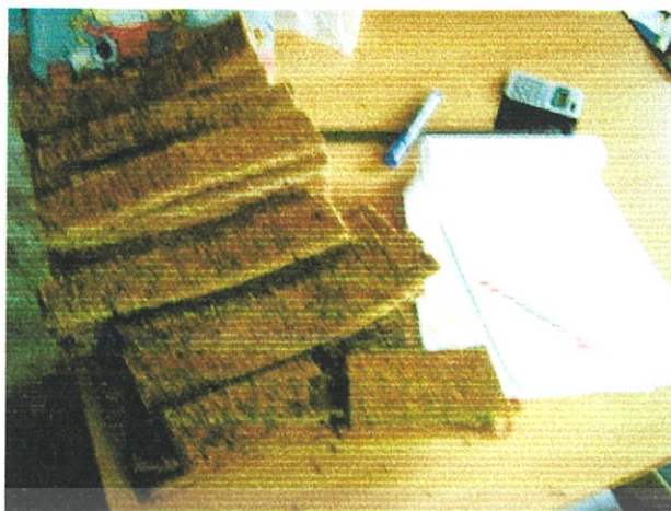
ภาพที่ 3.23 ชั้นทดสอบภายหลังการทดสอบแรงดัด
