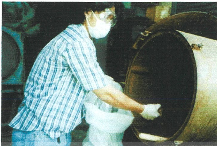
ภาพที่ 3.8 นำเปลือก, รกหุ้มเนื้อของฝักมะขามใส่ลงในเครื่องคลุกผสม
