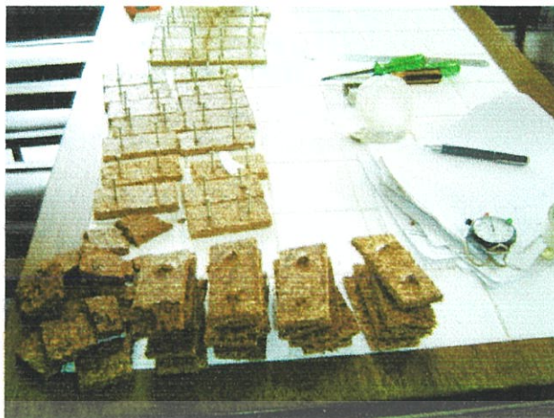
ภาพที่ 3.27 ชั้นทดสอบความยืดเหนียวของตะปูเกลียว
