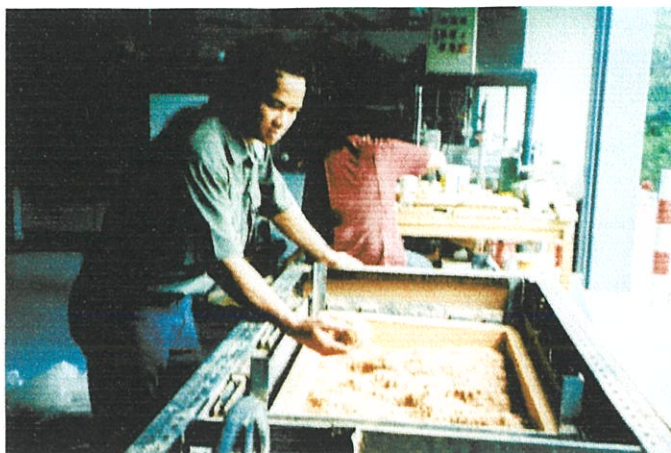
ภาพที่ 3.4 การร่อนเปลือกและรhumเนื้อของฝักมะขามในเครื่องร่อนตะแกรงเบอร์ 3
