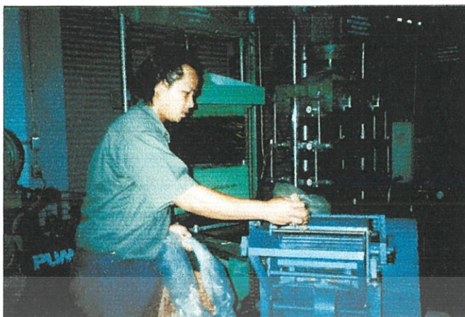
ภาพที่ 3.2 การตีสับ (Wing – beater Mills) รกหุ้มเนื้อ ของฝักมะขาม
