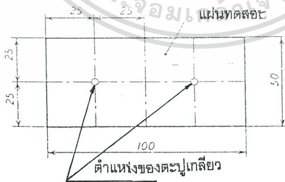
ภาพที่ 2.12 แสดงตำแหน่งการทดสอบความยึดเหนี่ยวของตะปูเกลียว
