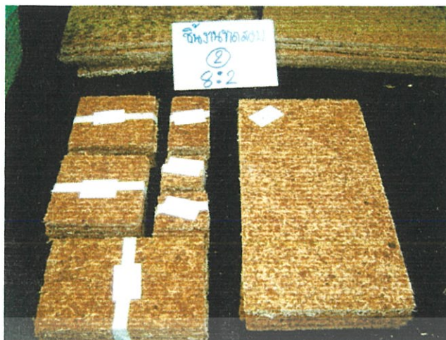
ภาพที่ 3.14 แสดงตัวอย่างการตัดแผ่นขึ้นทดสอบ
