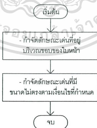
ภาพที่ 5.11 ขั้นตอนการตรวจหาบริเวณที่คาดว่าจะเป็ตาทั้งสองข้างจากลักษณะเด่นทั้งหมด
