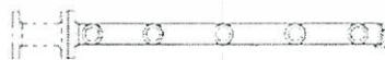
รูปที่ 2.19 แผ่นกระจายของเหลวแบบท่อเจาะรู [14]
