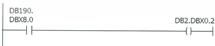
รูปที่ 3.29 การย้ายข้อมูลจากเอาต์พุตของฟังก์ชัน F_1002DI (FB190) ไปส่งให้วาล์วปิดหรือเปิดภายในโปรแกรมปรกติ (OB1)
