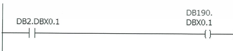
รูปที่ 3.27 การย้ายค่าอินพุตปกติ ตัวที่ 2 (OB1) มาอยู่ใน Safety Program
