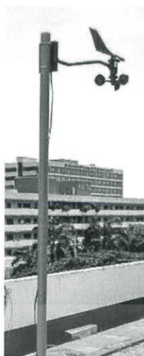
รูปที่ 3.29 Anemometer รุ่น DAVIS7911
