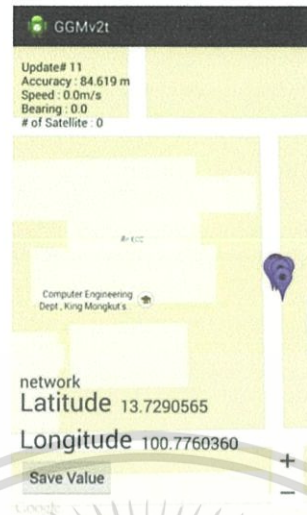
รูป 4.5 ตำแหน่งพิกัดตำแหน่งปัจจุบันเมื่อเปิด Network(Wi-Fi) อย่างเดียวโดยใช้ Location based
