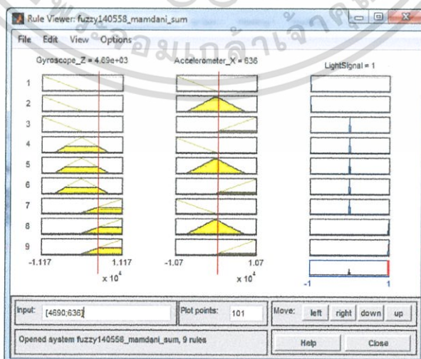
รูปที่ 4.29 ทดสอบค่า Output ใน MATLAB ที่ได้จากการกำหนด Defuzzification ด้วยวิธี MoM
