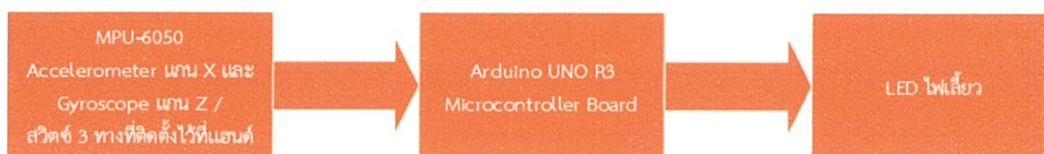
รูปที่ 3.3 Block diagram แสดงการทำงานของสัญญาณไฟเลียว
