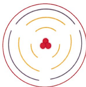
รูปที่ 3.3 การประกอบแผงหลอด LED เพื่อให้ได้การกระจายแสง 360 องศา
