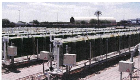
รูปที่ 2.4 เครื่องปฏิกรณ์เพาะเลี้ยงสาหร่ายแบบแผ่น [13]
