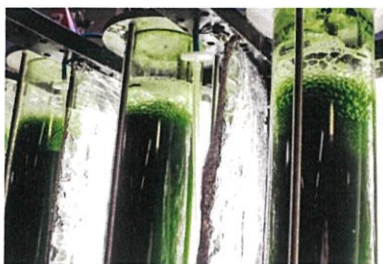
รูปที่ 2.6 เครื่องปฏิกรณ์เพาะเลี้ยงสาหร่ายแบบฟอง [15]
