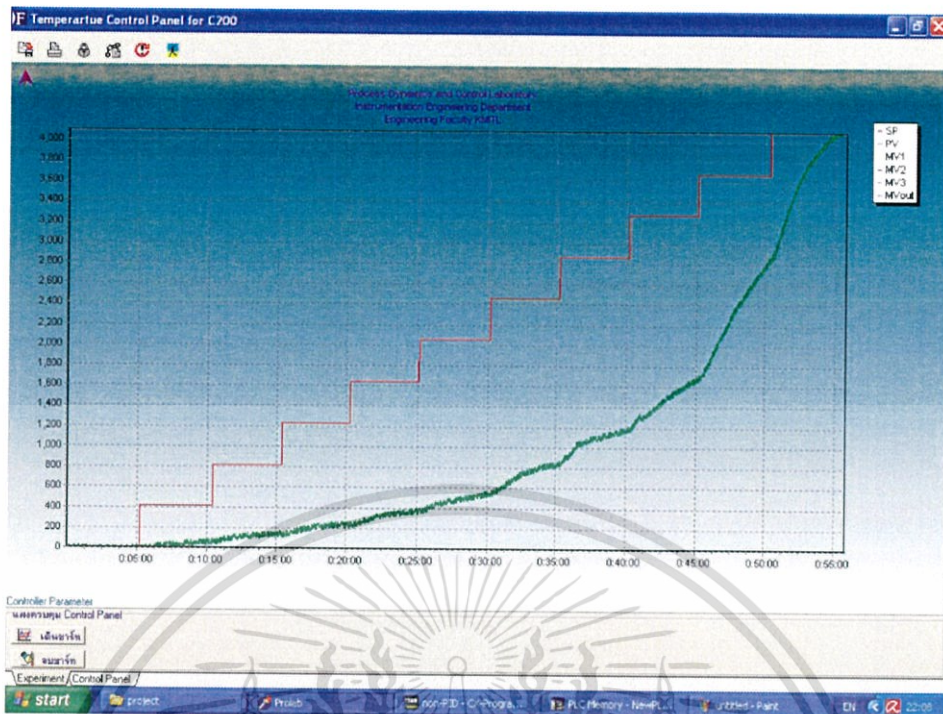
รูปที่ 4.4 แสดงค่า PV ของระบบเมื่อยังไม่ผ่านตัวควบคุม PID
