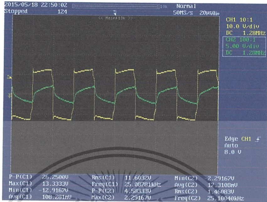
รูปที่ 4.15 รูปสัญญาณของแรงดันไฟฟ้าหลังออกจากหม้อแปลงไฟฟ้า
