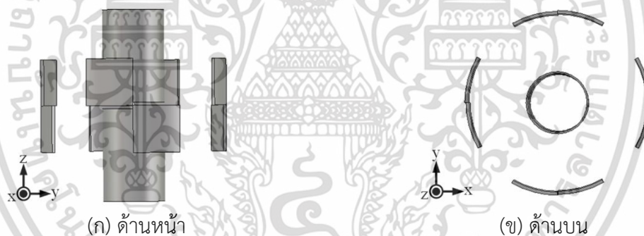
รูปที่ 3.10 การออกแบบสายอากาศไดโพลร่วมกับแผ่นพาราซิติคโค้ง
