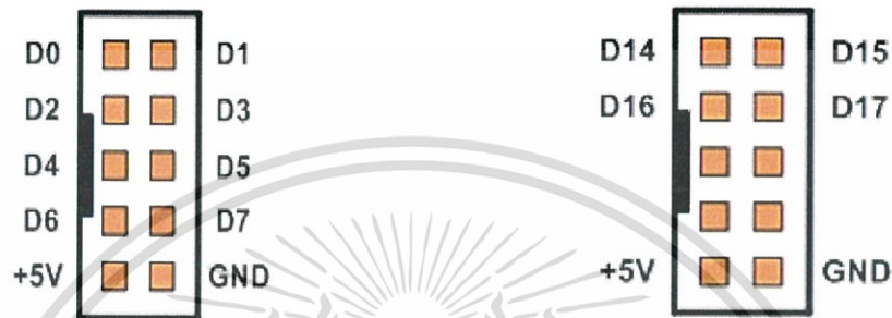
รูปภาพที่ 2.15 พอร์ตการเชื่อมต่อ Digital D0-D7 (ซ้าย) พอร์ตการเชื่อมต่อ Digital D14-D17 (ขวา) [ www.ett.co.th ]
