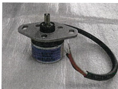
รูปที่ 2.20 แสดงลักษณะของโทแทนทีออมิเตอร์แบบหมุนที่ใช้ในงานอุตสาหกรรม
