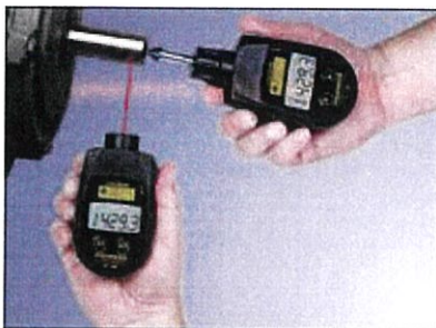
รูปที่ 2.31 แสดงการวัดโดยใช้เทคโนโลยีเลเซอร์
