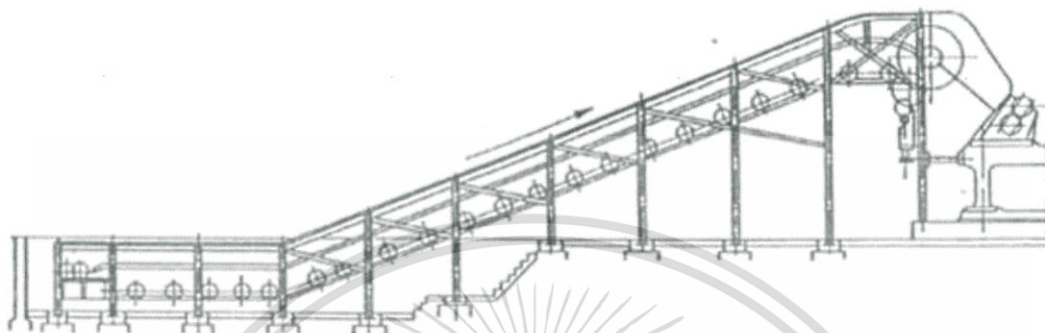
รูปที่ 2.4 ลักษณะสะพานลำเลียงอ้อยที่ใช้ในโรงงาน
