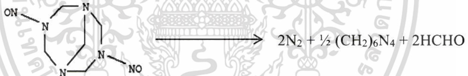
รูปที่ 2.6 กลไกปฏิกิริยาการสลายตัวของ DNPT [19]
