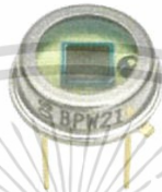
รูปที่ 3.16 ซีลีคอนโฟโตไดโอด รุ่น BPW21R
