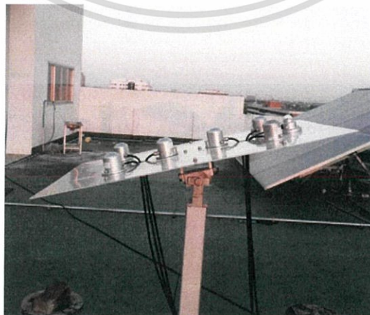
รูปที่ 3.30 แสดงแผ่นติดตั้งไพรานอมิเตอร์ที่ทำมุม 15^{\circ}
