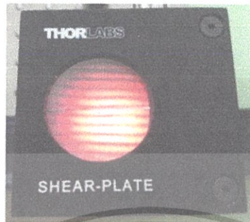
รูปที่ 3.8 ภาพริ้วการแทรกสอดของ HeNe Laser เมื่อเป็นลำแสงขนาน จากอุปกรณ์เชียร์เพลต
