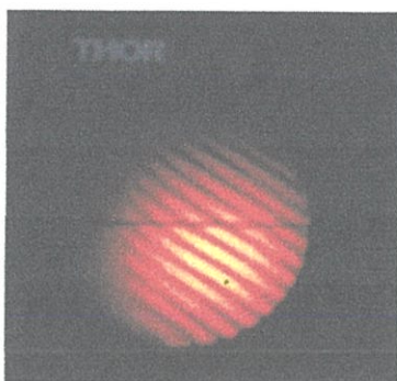
รูปที่ 3.11 ภาพริ้วการแทรกสอดของ He-Ne Laser เมื่อลำแสงไม่ขนาน จากอุปกรณ์ซีเรียเพลต
