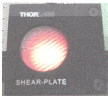
รูปที่ 3. 10 ภาพริ้วการแทรกสอดของ He-Ne Laser เมื่อลำแสงไม่ขนาน จากอุปกรณ์เชียร์เพลต
