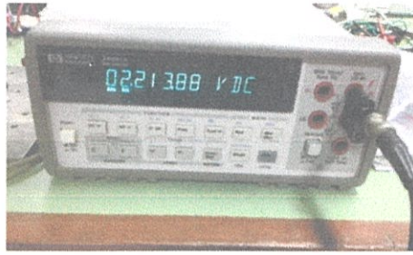
รูปที่ 3.26 digital multimeter อ่านค่าความเข้มแสงของรีจิวการแทรกสอดเป็นค่าโวลต์เตจ
