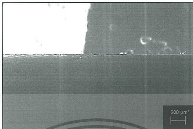
รูปที่ 4.8 ภาพตัดขวางของชิ้นงานที่ได้จากการรมดำด้วยสารละลายโซเดียมไฮดรอกไซด์เข้มข้น 30% โดยมวลต่อปริมาตร กับไฮดรอกซีลีนไฮเดรต เข้มข้น 2 เท่า (5.6 ไมโครลิตร) โดยเทคนิค SEM ที่กำลังขยาย 500 เท่า
