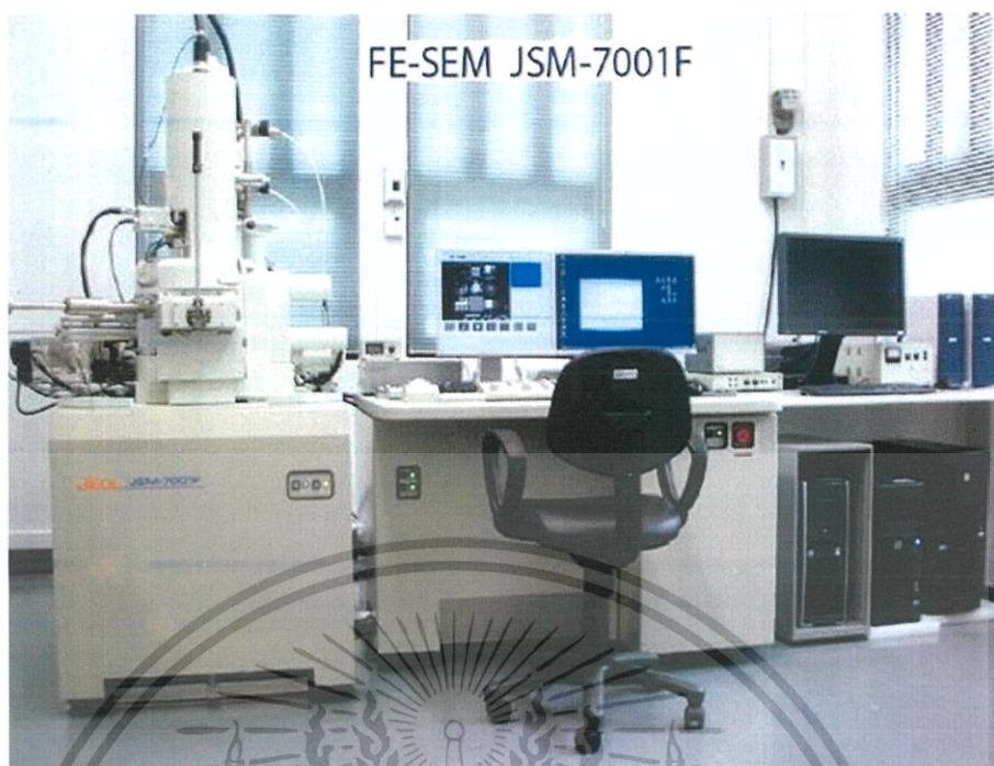
รูปที่ 2.32 เครื่อง Field emission scanning electron microscope (FE-SEM) รุ่น JSM-7001F [67]
