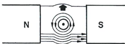
(ข) เส้นแรงแม่เหล็กรอบๆตัวนำที่มีกระแสไหล
