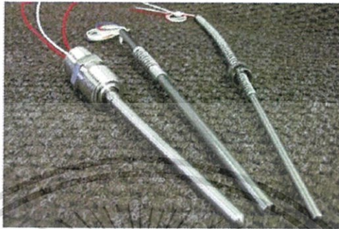
รูปที่ 2.4 แสดงลักษณะของเทอร์โมคัปเปิลที่ใช้งานจริง
