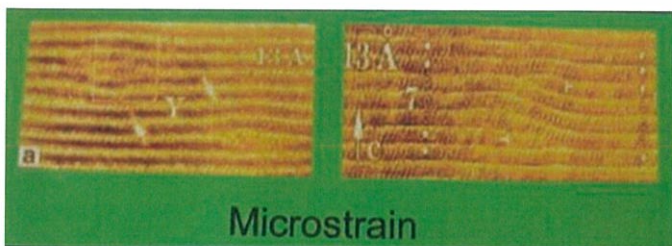
รูปที่ 2.13 วิเคราะห์ขนาดของผลึก และความเครียดระดับจุลภาค
