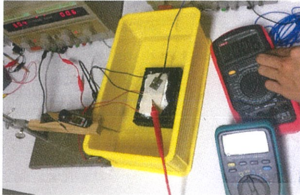
รูปที่ 3.5 แสดงการทดลองวัดค่าอุณหภูมิของเทอร์โมอิเล็กทริก 2 หน่วยต่อขนานกัน
