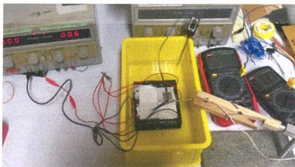
รูปที่ 3.7 แสดงการทดลองวัดค่าอุณหภูมิของเทอร์โมอิเล็กทริก 4 หน่วยต่อขนานกัน
