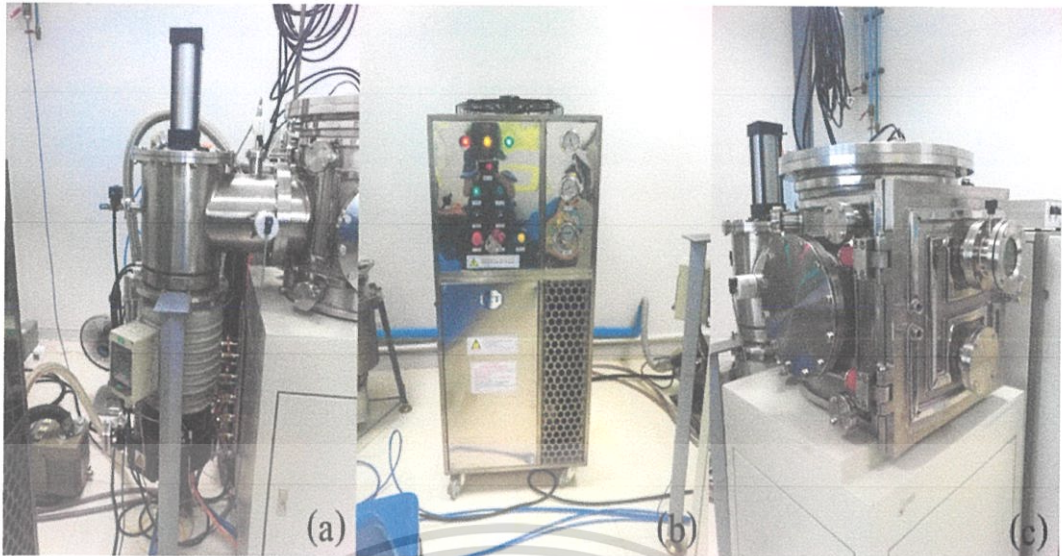
รูปที่ 3.10 ภาพแสดงส่วนประกอบของเครื่องตีซีแมกนีตรอนสปีดเตอริง (a) ถังขจัดลดความร้อน (b) เครื่องทำความเย็น และ (c) ห้องเคลือบสุญญากาศ
