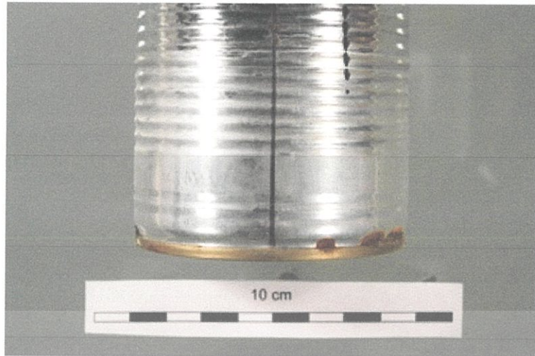
รูปที่ 2.48 ภาพแสดงการกัดกร่อนบริเวณขอบกระป๋องบรรจุอาหาร
