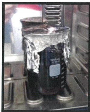
รูปที่ 3.5 นำปิกเกอร์เข้าเตาอบเพื่อให้แอลกอฮอล์ระเหยออกจนหมด
