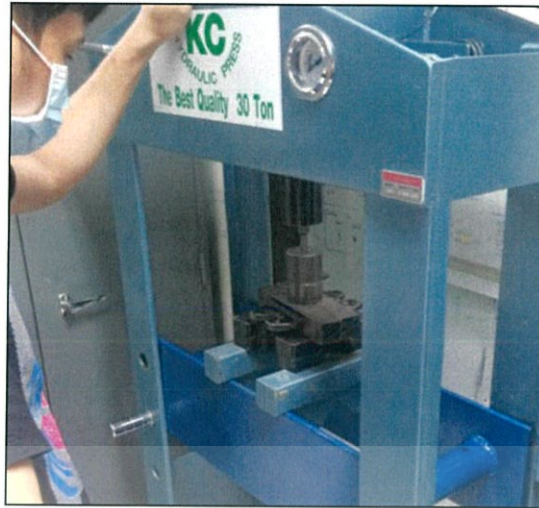
รูปที่ 3.9 นำบล็อกไปอัดด้วยเครื่องอัดสาร (Hydraulic)
