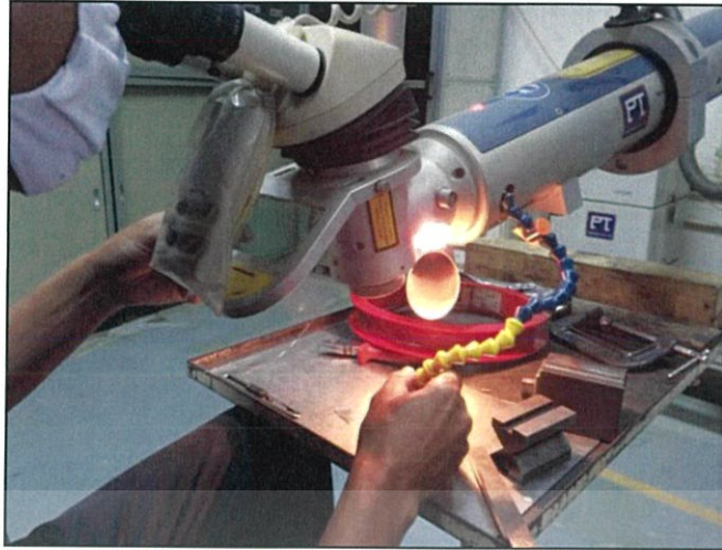
รูปที่ 3.19 เชื่อมแผ่นสแตนเลสกับแท่งสารด้วยเครื่องเชื่อมสแตนเลส
