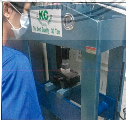
รูปที่ 3.13 นำบล็อกไปอัดด้วยเครื่องอัดสาร (Hydraulic)
