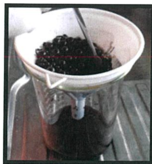
รูปที่ 3.4 นำสารประกอบ \text{CuCr}_{1/2}\text{Fe}_{1/2}\text{O}_2 เทลงในบีกเกอร์แยกกับเม็ดเซอร์โคเนีย
