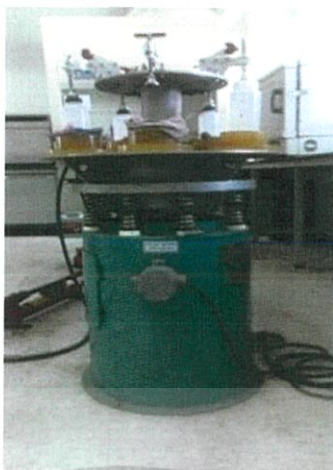
รูปที่ 2.8 เครื่องบดสารด้วยแรงสั่น (Vibration Mill) [5]
