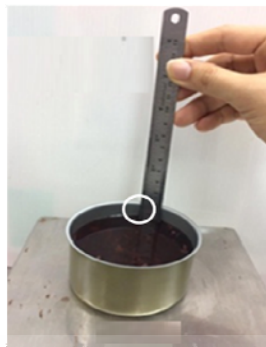
รูปที่ 1 ช่องว่างเหนืออาหาร (Headspace) ของโถ้วข้าวไรซ์เบอร์รี่บรรจุกระป๋อง
