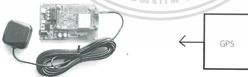
รูปที่ 2.17 โมดูลจีพีเอสและรูปสี่เหลี่ยมแทนโมดูลจีพีเอส [10]
