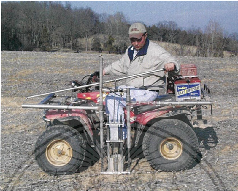
รูปที่ 2.5 Soil sampling machine ติดตั้งบน ATV [3]
