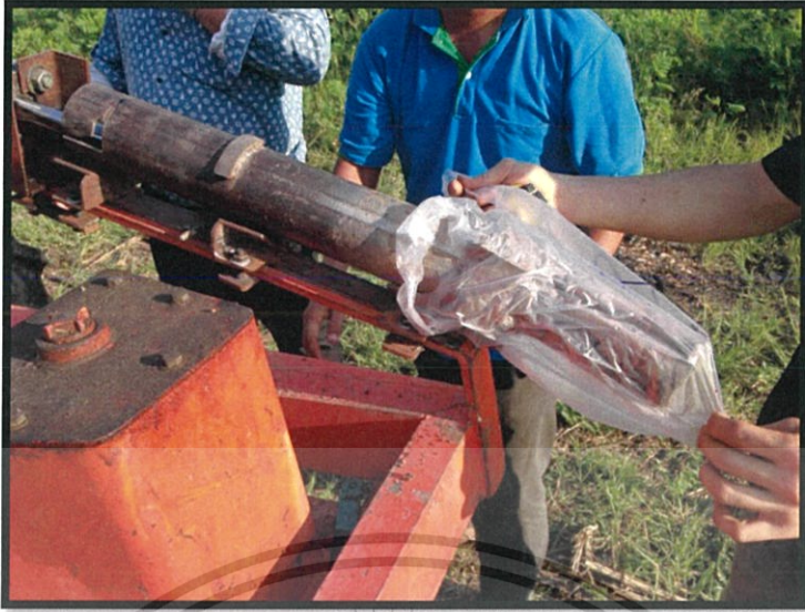
รูปที่ 4.5 ดันดินออกจากกระบอกเก็บตัวอย่างและเก็บใส่ถุงพลาสติกเพื่อนำไปวิเคราะห์
