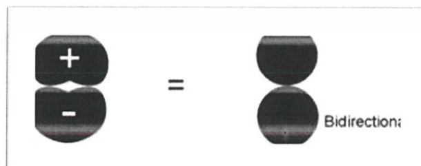
รูป 2.9 แสดงการรวมกันของ cardioid ขั้วบวกกับขั้วลบของ Bidirectional
