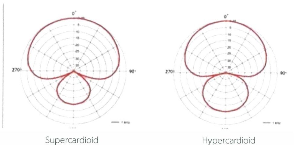
รูป 2.6 แสดงการรับเสียงทั้งด้านหน้าไมโครโฟนและด้านหลังไมโครโฟน (Super Cardioid & Hyper Cardioid)
