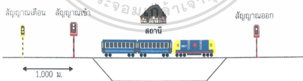
รูปที่ 2.2 สัญญาณเตือนของระบบไฟสีติดตั้งอยู่หน้าสัญญาณเข้ามากกว่าระยะเบรก
