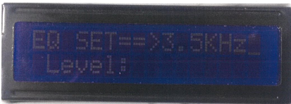
รูปที่ 4.6 เข้าสู่โหมดการปรับแต่งเสียงของวงจร Equalizer เพื่อเป็นตัวปรับความดังของความถี่เสียงที่ 3.5 KHz
