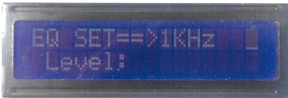
รูปที่ 4.5 เข้าสู่โหมดการปรับแต่งเสียงของวงจร Equalizer เพื่อเป็นตัวปรับความดังของความถี่เสียงที่ 1 KHz
