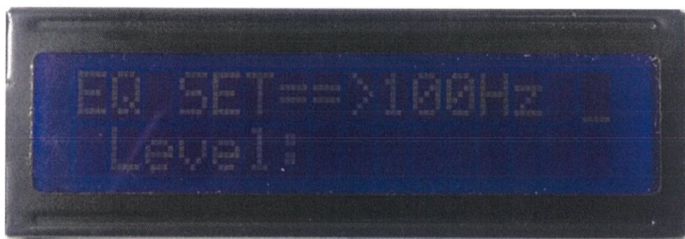
รูปที่ 4.3 เข้าสู่โหมดการปรับแต่งเสียงของวงจร Equalizer เพื่อเป็นตัวปรับความดังของความถี่เสียงที่ 100 Hz
