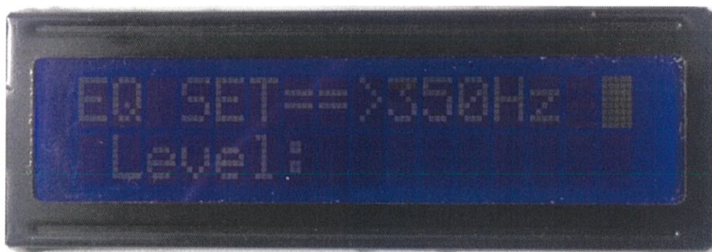
รูปที่ 4.4 เข้าสู่โหมดการปรับแต่งเสียงของวงจร Equalizer เพื่อเป็นตัวปรับความดังของความถี่เสียงที่ 350 Hz
