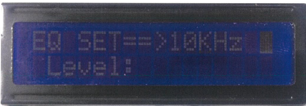
รูปที่ 4.7 เข้าสู่โหมดการปรับแต่งเสียงของวงจร Equalizer เพื่อเป็นตัวปรับความดังของความถี่เสียงที่ 10 KHz
