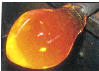
รูปที่ 2.1 การเป่าแก้ว-กระเปาะแก้วร้อนที่ปลายท่อฝั่งเย็น
