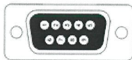
รูปที่ 2.3 DB9 ตัวผู้เมื่อมองจากด้านหลัง
