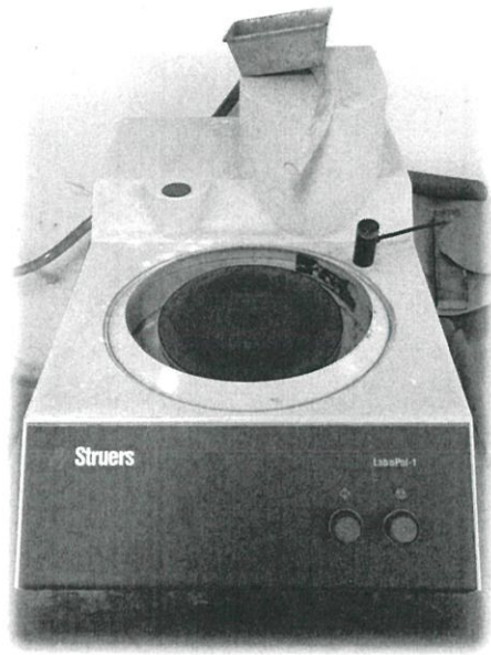
รูปที่ 3.13 เครื่องขัดใช้ในการหน้าตัดของ ชิ้นงานที่หล่อในเรซิน
