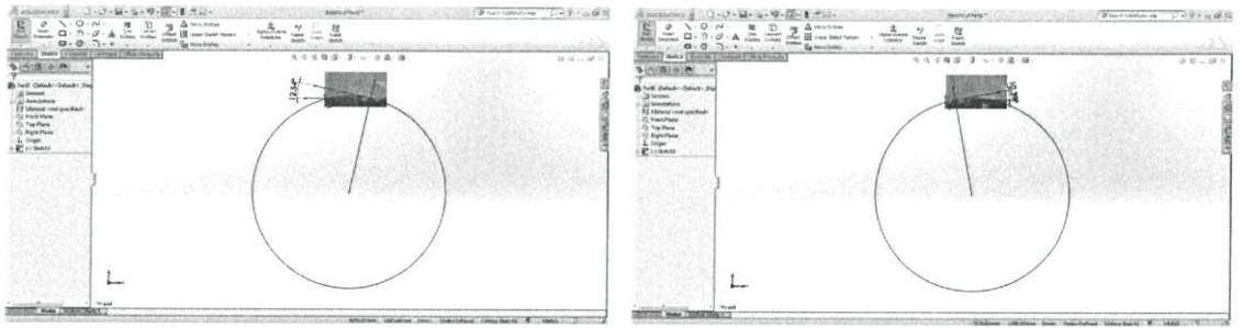
รูปที่ ค.14 การหาค่ามุมสัมผัสด้านขวาและซ้ายของ SAC + Mn-doped TiO 2 1.00 wt% ชั้นงานที่ 2
