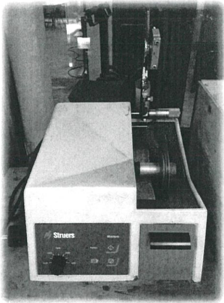
รูปที่ 3.12 เครื่องตัดโลหะใช้ในการผ่าครึ่งโลหะบัดกรี บนแผ่นรองทองแดงหลังการหลอม
