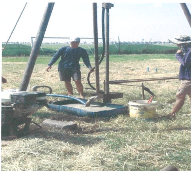
รูปที่ 3.13 การเก็บตัวอย่างดินแบบไม่ถูกรบกวน ( Undisturbed Soil Sampling)
