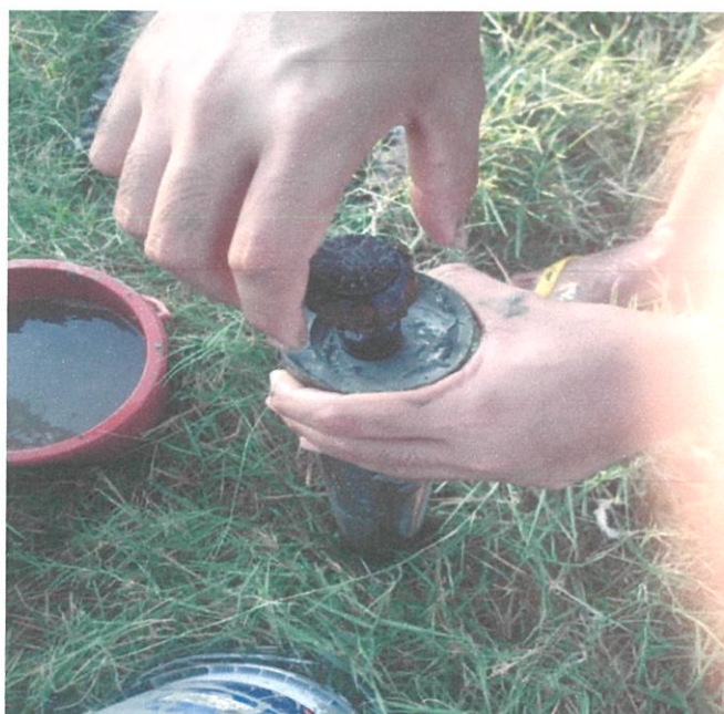
รูปที่ 3.14 นำดินที่เก็บตัวอย่างมาทดสอบกำลังรับแรงเฉือน
