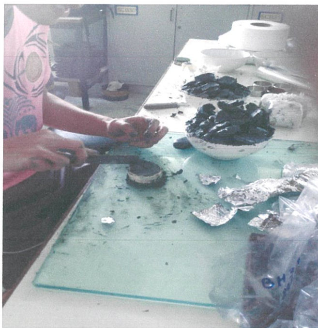
รูปที่ 3.21 การทดลองหาหน่วยน้ำหนักของดิน
