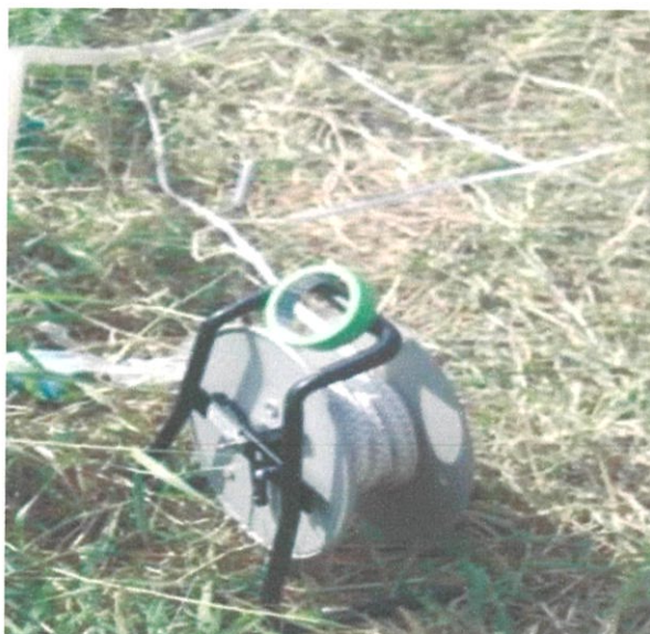
รูปที่ 3.7 เครื่องมือวัดระดับน้ำพร้อมเทปวัดระยะ ( Water Level Meter)
