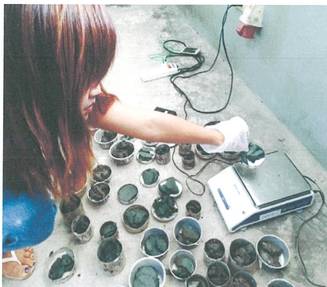
รูปที่ 3.15 นำดินที่เก็บตัวอย่างมาทดสอบหาปริมาณน้ำในดิน ( Water Content)
