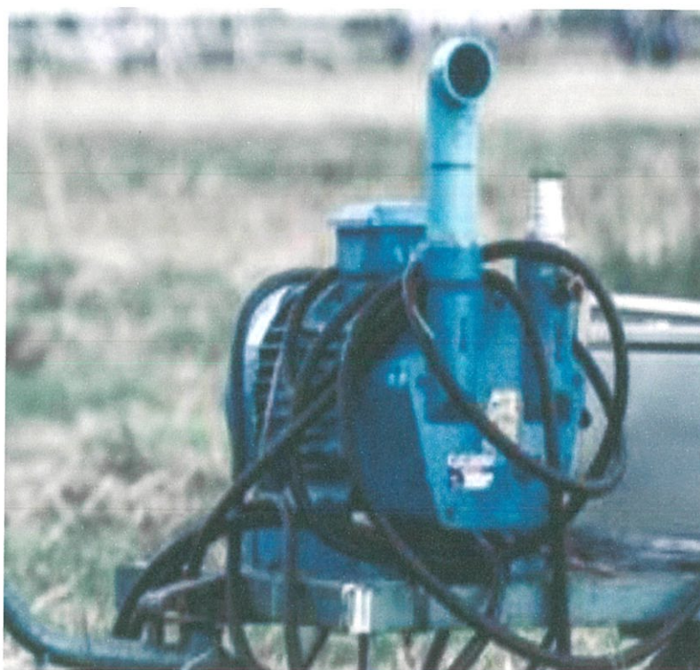
รูปที่ 3.8 เครื่องสูบน้ำสุญญากาศ รุ่น VK – 120 Single – Stage Liquid Ring Vacuum Pump
