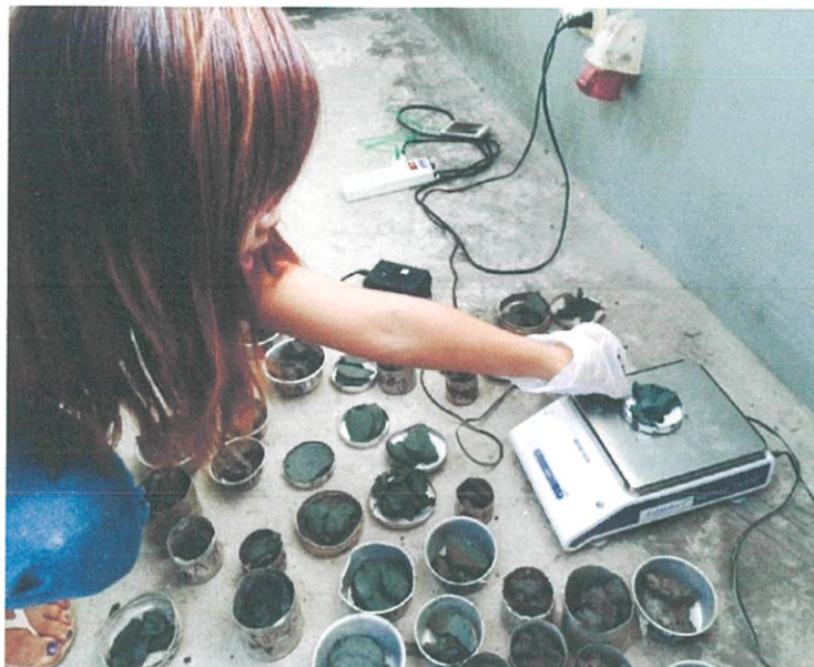
รูปที่ 3.20 การหาปริมาณน้ำในมวลดิน ( Water content)
