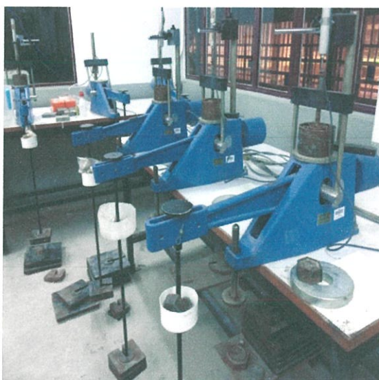
รูปที่ 3.24 การทดสอบหาค่าการทรุดตัวของดิน
