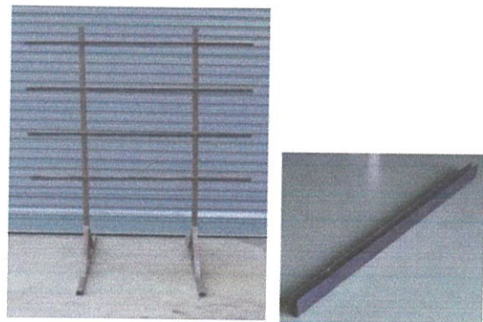
รูปที่ 5 แท่นทดสอบ(ซ้าย) ร่องสลีตจำลอง(ขวา)
