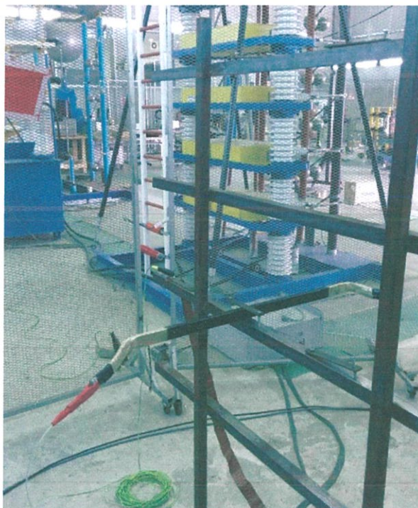
รูปที่ 4.9 วงจรทดสอบจริงของขดลวดสเตเตอร์
