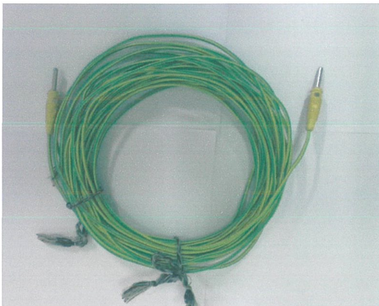
รูปที่ 3.11 สายกราวด์ (Ground wire)
