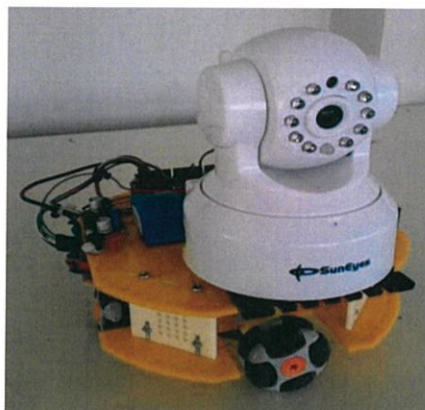
รูปที่ 3.8 โครงสร้างหุ่นที่ติดตั้งกล้องไอพี (IP Camera) แล้ว
