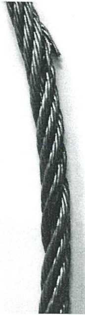
รูปที่ 5.29 รูปการเสียหายของลวดสลิง
