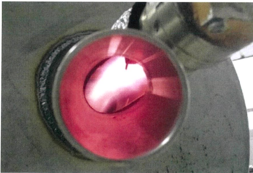
รูปที่ 5.4 แสดงตำแหน่งของเปลวไฟนําร่องที่ปริมาณแก๊ส LPG 3.5 ลิตรต่อหน้าที่ จากด้านหน้าของเตาเผา
