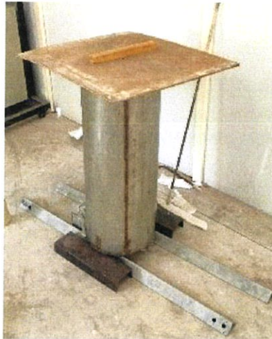
รูปที่ 4.11 ภาพหลังจากเสร็จสิ้นการเทพูน
