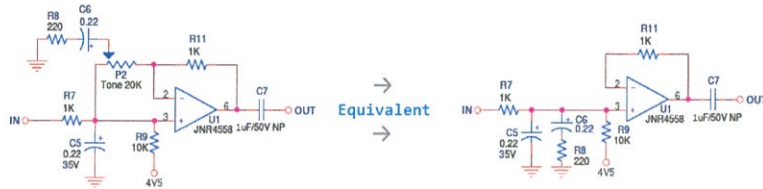
รูปที่ 3.32 รูปวงจรเปรียบเทียบขณะปรับโทนสูงสุด
