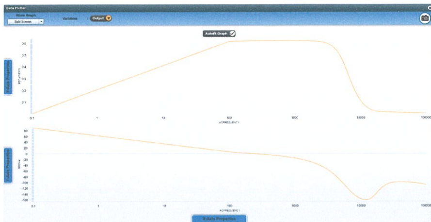
รูปที่ 4.49 กราฟแสดงผลตอบสนองทางความถี่ของวงจรส่วน Reconstruction Filter
