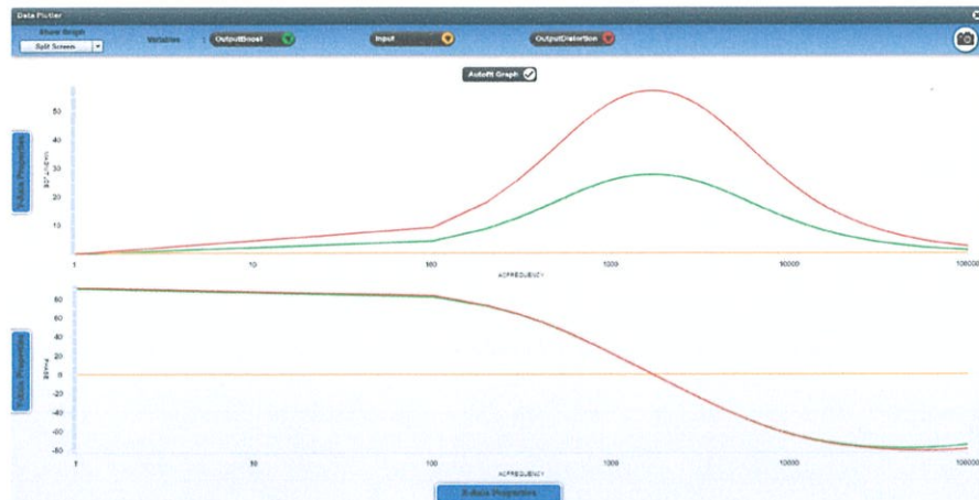
รูปที่ 4.38 กราฟแสดงผลตอบสนองทางความถี่ของวงจรบัสเมื่อปรับ Boost = max, Drive = min
