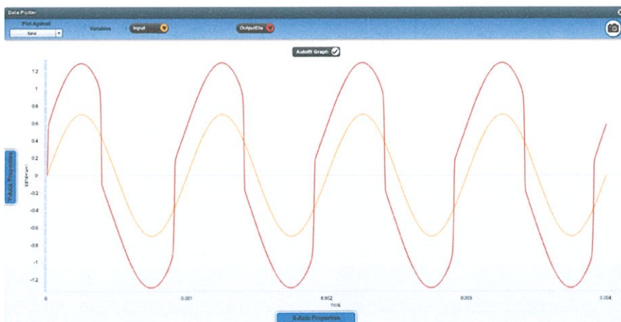
รูปที่ 4.17 กราฟแสดงผลตอบสนองทางเวลาของวงจรตัดยอดสัญญาณแบบสมมาตรด้วยมอสเฟต
