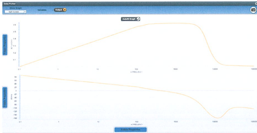
รูปที่ 4.47 กราฟแสดงผลตอบสนองทางความถี่ของวงจรมั่น Anti-aliasing Filter
