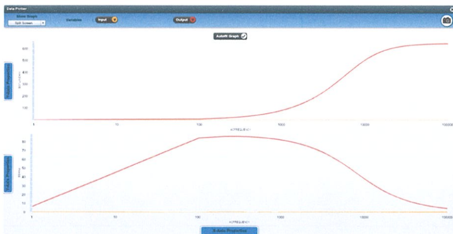
รูปที่ 4.8 กราฟแสดงผลตอบสนองทางความถี่ของวงจร Diode Clipping แบบไม่สมมาตรด้านลบ
