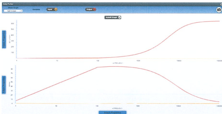
รูปที่ 4.6 กราฟแสดงผลตอบสนองทางความถี่ของวงจร Diode clipping แบบไม่สมมาตรด้านบวก
