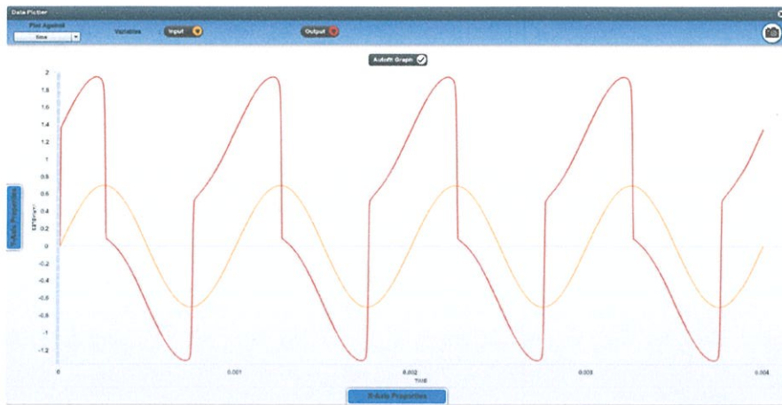
รูปที่ 4.5 กราฟแสดงผลตอบสนองทางเวลาของวงจร Diode clipping แบบไม่สมมาตรด้านบวก
