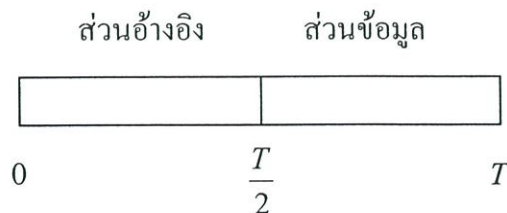
รูปที่ 3.10 รูปแบบของสัญญาณ DCSK ที่ถูกแบ่งออกเป็น 2 ส่วน คือ ส่วนอ้างอิงและ ส่วนข้อมูล
