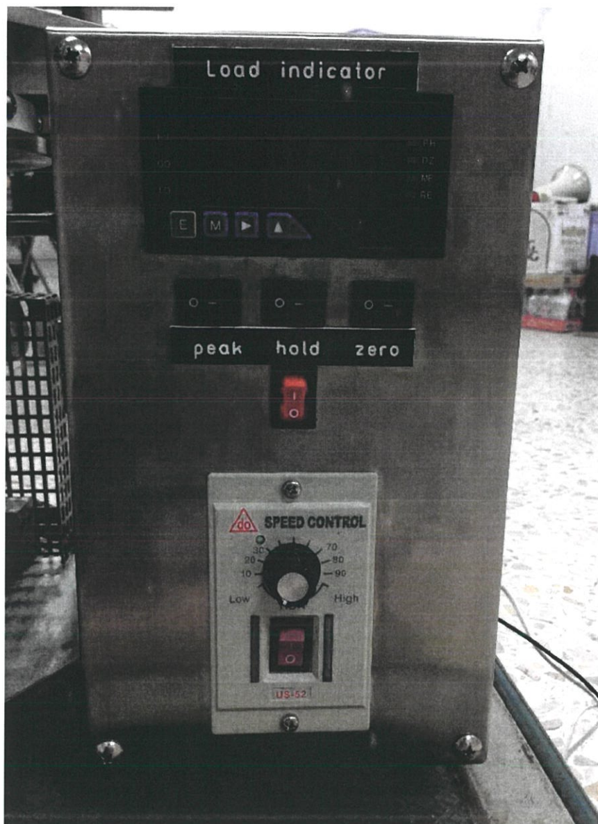
รูปที่ 3.10 หน้าจอแสดงผลและชุดควบคุมความเร็วรอบมอเตอร์
