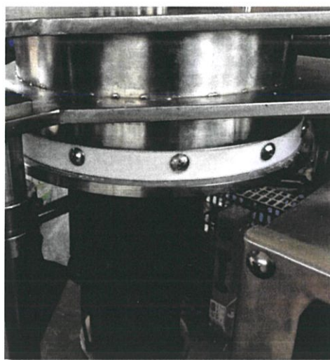
รูปที่ 3.19 หลังติดแผ่นเทปลอน
