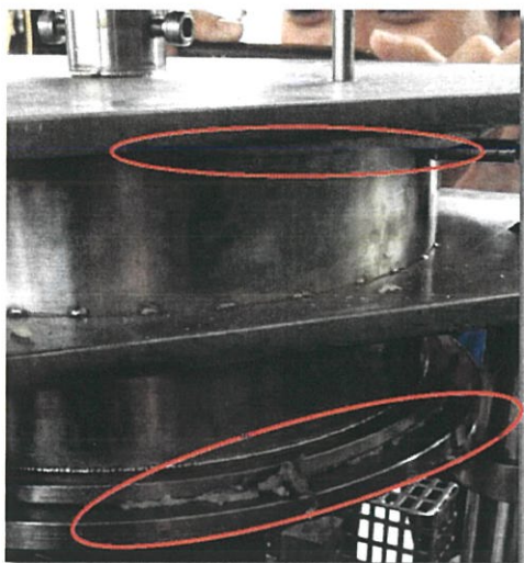
รูปที่ 3.18 ก่อนติดแผ่นเทปลอน
