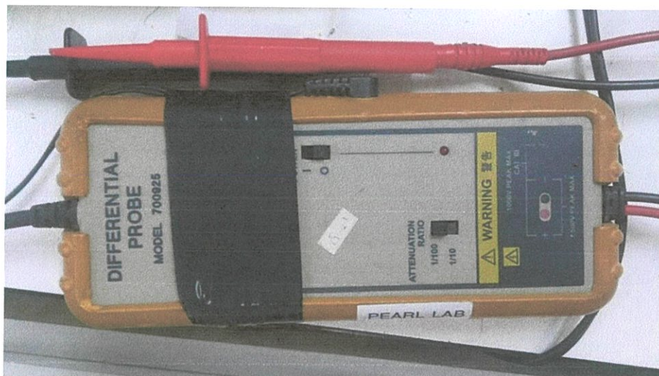
รูปที่ ค.3 Differential Probe YOKOGAWA รุ่น 700625
