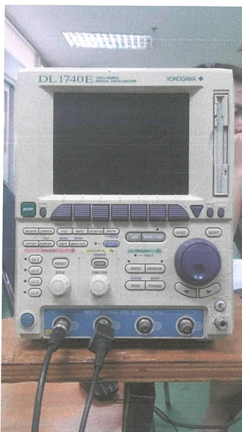
รูปที่ ค.1 ดิจิตอลออสซิโลสโคป YOKOGAWA รุ่น DL1740E
