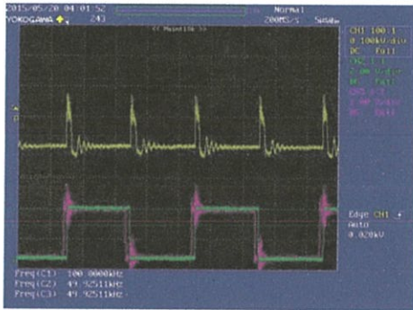
รูปที่ 8 แรงดันจุด A เปรียบเทียบกับสัญญาณสวิตช์ Q2, Q3 ช่วงการสวิตช์โดยที่ Duty มีค่าประมาณ 1
