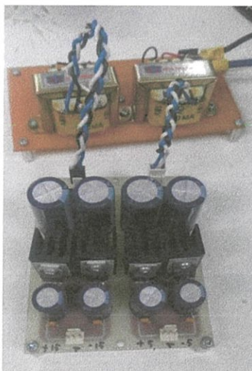
รูปที่ 3.15 วงจรเรียงกระแสสำหรับวงจรตรวจวัดสัญญาณที่สร้างขึ้น
