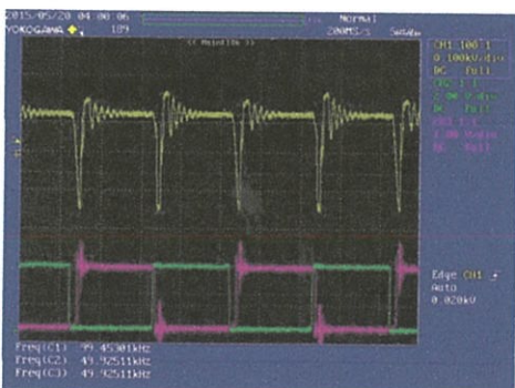
รูปที่ 10 แรงดันจุด A เปรียบเทียบกับสัญญาณสวิตช์ Q2, Q3 ช่วงการสวิตช์โดยที่ Duty มีค่าประมาณ 0
